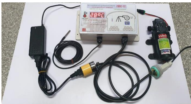
ระบบการต่อกล่องควบคุมกับมอเตอร์ปั้มน้ำ
